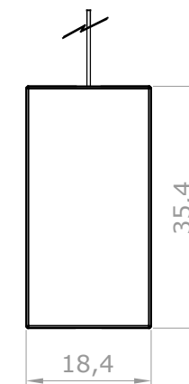
Détail 1:1 barre de charge apparente Slim 35
